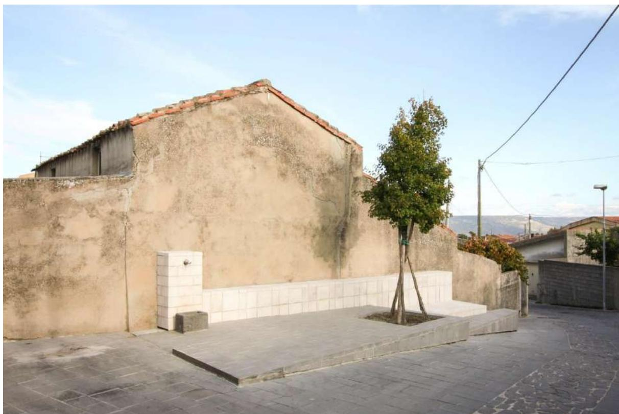
Figura 30. Al final de la subida, donde la calle es ya más plana, se dispone una ligera rampa para facilitar el acceso a las personas de movilidad reducida, y justo ahí se sitúa el pedestal de la fuente, integrado con el largo banco, y creando así un elemento que recuerda a los abrevaderos presentes en el campo próximo. (A. Montis).
